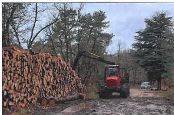
Porteur déchargeant du bois © ONF (2021)
